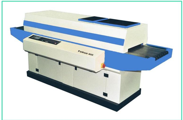
**Unsere technische Physik:** langwellige IR-Strahler kombiniert mit automatisch geregelter Heißluft ergeben ein heute notwendiges, modernes Reflow-Lötsystem. Die kritischen Punkte sind Temperaturgenauigkeit, Profilstabilität und Profilverflexibilität. Die 7 + 7 (oben + unten) Zonen der Fokus replizieren problemlos ideale Profile für verschiedenste Lotpasten.
